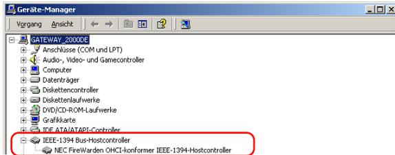
Der IEEE-1394-Anschluss sollte in Ihrem System unter »**IEEE-1394-Bus Host-Controller**« aufgelistet werden.
