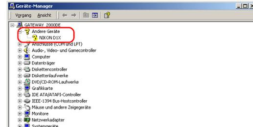
Falls »Nikon I394 Protocol Device« nicht im Geräte-Manager, und »NIKON DIX(oder DI/DIH)« nicht unter »Andere Geräte« aufgelistet ist, bitte die Kamera abtrennen, und den Computer rebooten. Danach die Kamera wieder an den Rechner anschließen.
